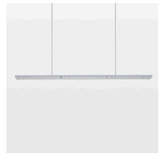
Pendelleuchte mit LED, Bemessungslbensdauer der LED L90/B50 50000 h (Tambient 25°C), Farbwiedergabeindex CRI > 80, Farborttoleranz 3 SDCM (initial), doppelt asymmetrisches Lichtbild mit deutlich erhöhter horizontaler Aufhellung, Kombination aus asymmetrischen PMMA Linsen und 30° TIR Linsen aus PMMA, Leuchtgehäuse Stahlblech, pulverbeschichtet, silber matt, Stromführung über Abhängeseile
