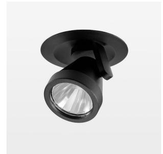
Halbeinbauleuchte mit LED, Bemessungslebensdauer der LED L80/B10 50000 h (Tambient 25°C), Farbwiedergabeindex CRI > 96, Farborttoleranz 2 SDCM (initial), rotationssymmetrischer Reflektor mit kreisförmigen Lichtbild, Reflektor Reinstaluminium 99,99% in MIRO-Silver®, segmentiert und facettiert, LED Hybrid-Technologie, 3D-Linse Silikon zur Reduzierung des Streulichtanteils, Aluminium-Druckguss, pulverbeschichtet, Drehwinkel 400°, Schwenkwinkel +/- 85°, schwarz, separate Treibereinheit
