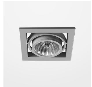
Einbauleuchte mit LED, Bemessungslebensdauer der LED L80/B10 > 50000 h, Farbwiedergabeindex CRI > 80, Farborttoleranz 2 SDCM (initial), Reflektor mit kreisförmigem Lichtbild, Reflektor Reinstaluminium 99,99% in MIRO-Silver®, kardanisch, Schwenkwinkel +/-30°, Leuchtgehäuse Stahlblech, pulverbeschichtet, schwarz, separate Treibereinheit
