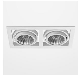
Einbauleuchte mit LED, Bemessungslebensdauer der LED L80/B10 > 50000 h, Farbwiedergabeindex CRI > 90, Farborttoleranz 2 SDCM (initial), rotationssymmetrischer Reflektor mit kreisförmigen Lichtbild, Schwenkwinkel +/- 30°, Leuchtgehäuse Stahlblech, pulverbeschichteter Weiss, separate Treibereinheit
