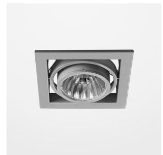
Einbauleuchte mit LED, Bemessungslebensdauer der LED L80/B10 > 50000 h, Farbwiedergabeindex CRI > 80, Farborttoleranz 2 SDCM (initial), Reflektor mit kreisförmigem Lichtbild, Reflektor Reinstaluminium 99,99% in MIRO-Silver®, kardanisch, Schwenkwinkel +/-30°, Leuchtgehäuse Stahlblech, pulverbeschichtet, silber, separate Treibereinheit
