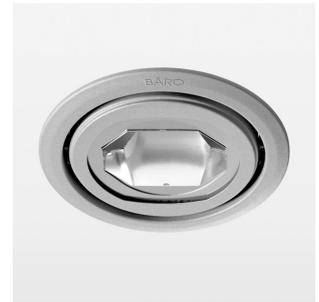
Einbauleuchte mit LED, Bemessungslebensdauer der LED L80/B10 > 50000 h, Farbwiedergabeindex CRI > 80, Farborttoleranz 2 SDCM (initial), Reflektor mit ovalem Lichtbild, Reflektor Reinstaluminium 99,99% in MIRO-Silver®, Drehwinkel 170°, Schwenkwinkel +/-30°, Leuchtengehäuse Stahlblech, pulverbeschichtet, silber, separate Treibereinheit
