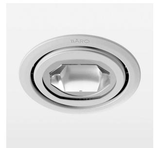
Einbauleuchte mit LED, Bemessungslebensdauer der LED L80/B10 > 50000 h, Farbwiedergabeindex CRI > 80, Farborttoleranz 2 SDCM (initial), Reflektor mit ovalem Lichtbild, Reflektor Reinstaluminium 99,99% in MIRO-Silver®, Drehwinkel 170°, Schwenkwinkel +/-30°, Leuchtgehäuse Stahlblech, pulverbeschichtet, Weiss, separate Treibereinheit
