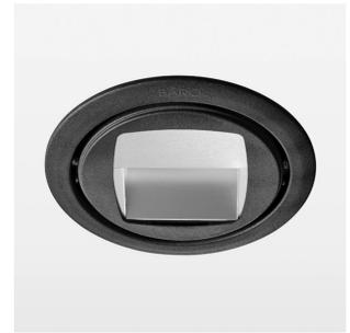
Einbauleuchte mit LED, Bemessungslebensdauer der LED L80/B10 > 50000 h, Farbwiedergabeindex CRI > 96, Farborttoleranz 2 SDCM (initial), Reflektor mit asymmetrischem Lichtbild, Reflektor Reinstaluminium 99,99% in MIRO-Silver®, Drehwinkel 170°, Schwenkwinkel 15°, Leuchtengehäuse Stahlblech, pulverbeschichtet, schwarz, separate Treibereinheit
