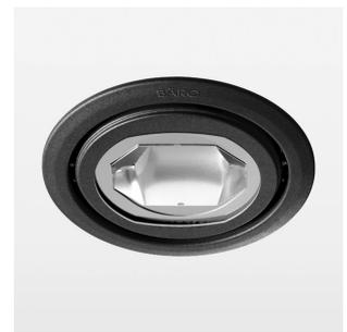
Einbauleuchte mit LED, Bemessungslebensdauer der LED L80/B10 > 50000 h, Farbwiedergabeindex CRI > 70, Farborttoleranz 2 SDCM (initial), Reflektor mit kreisförmigem Lichtbild, Reflektor Reinstaluminium 99,99% in MIRO-Silver®, Drehwinkel 170°, Schwenkwinkel +/-30°, Leuchtgehäuse Stahlblech, pulverbeschichtet, schwarz, separate Treibereinheit
