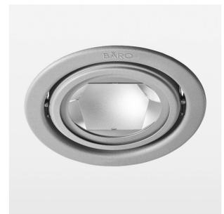
Einbauleuchte mit LED, Bemessungslebensdauer der LED L80/B10 > 50000 h, Farbwiedergabeindex CRI > 90, Farborttoleranz 2 SDCM (initial), Reflektor mit kreisförmigem Lichtbild, Reflektor Reinstaluminium 99,99% in MIRO-Silver®, Schwenkwinkel +/-25°, Leuchtgehäuse Stahlblech, pulverbeschichtet, silber, separate Treibereinheit
