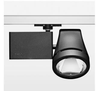
Aufbauleuchte mit LED, Bemessungslebensdauer der LED L80/B10 50000 h (Tambient 25°C), Farbwiedergabeindex CRI > 80, Farborttoleranz 2 SDCM (initial), rotationssymmetrischer Reflektor mit kreisförmigen Lichtbild, Reflektor Reinstaluminium 99,99% in MIRO-Silver®, Leuchtengehäuse Aluminium-Druckguss, pulverbeschichtet, schwarz, Drehwinkel 350°, Schwenkwinkel 210°, Multiadapter, On/Off, max. Anzahl Leuchten pro Stromkreis 34 Stk. / B16A
